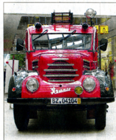
Der 1955 im Zittauer Garant-Werk gebaute Granit K 30 war mit 50 PS bestückt und 80 km/h schnell, tat bis 1996 (!) in Hoyerswerda Dienst.
